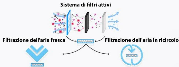
L'aria di alimentazione filtrata e il ricircolo dell'aria di scarico separati assicurano un parziale ricambio d'aria nei locali interni e nei letti. In questo modo si evita l'accumulo o la distribuzione di aerosol.
